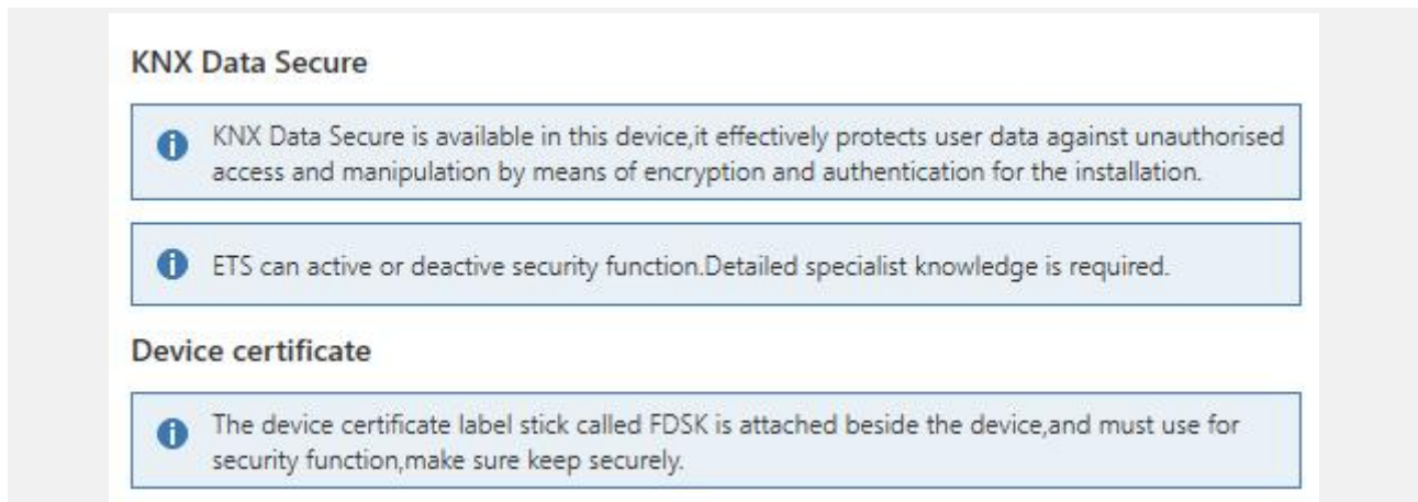
Fig.4.1 (1) "KNX Secure" parameter window
